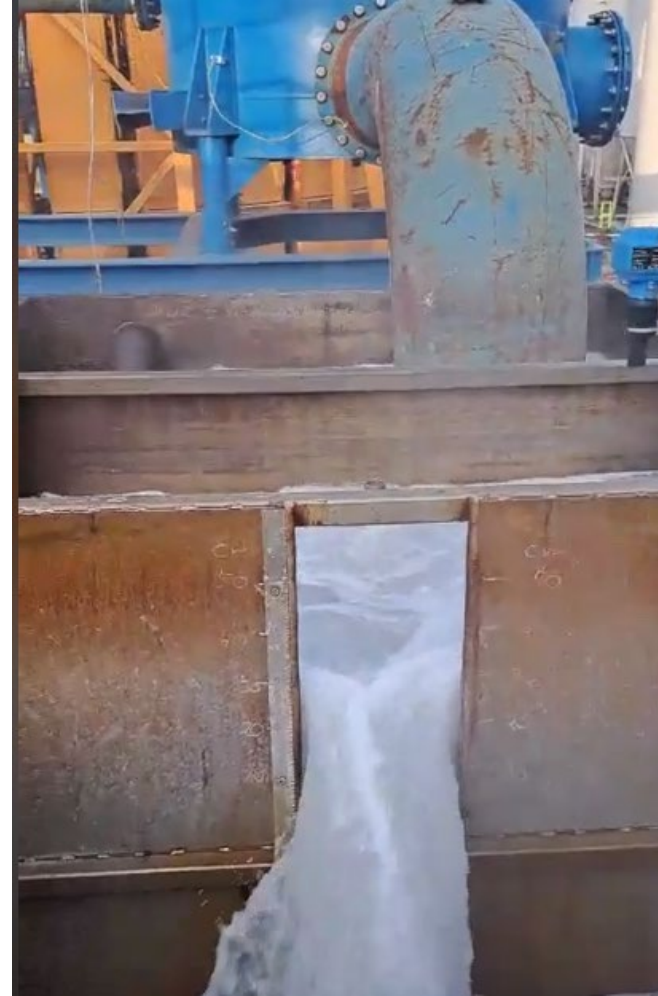
Test der Bohrung Gt Nn 4/23 Neuruppin
