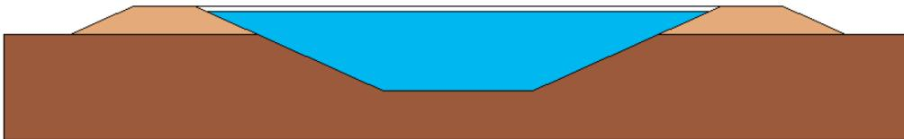
Abbildung 13: Skizze eines Erdbeckenspeichers mit schwimmender Abdeckung (Jensen 2014)
