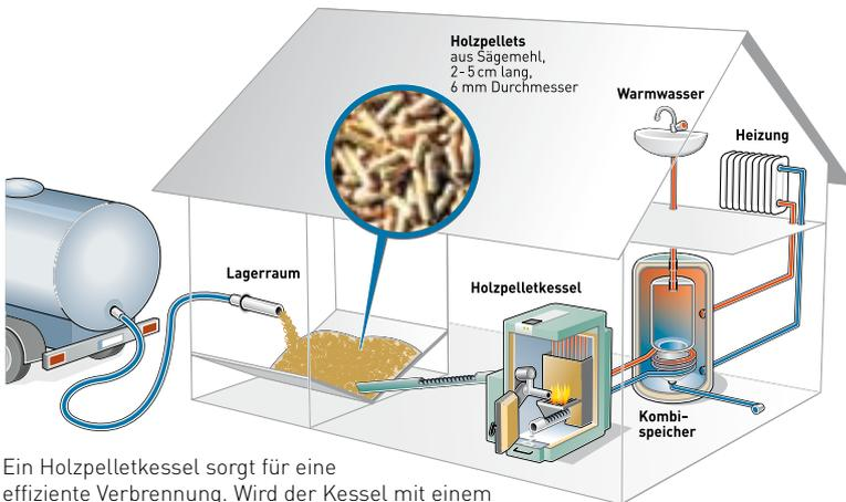
Ein Holzpelletkessel sorgt für eine effiziente Verbrennung. Wird der Kessel mit einem Pufferspeicher gekoppelt, können Emissionen weiter gesenkt und besonders hohe Wirkungsgrade erreicht werden.
