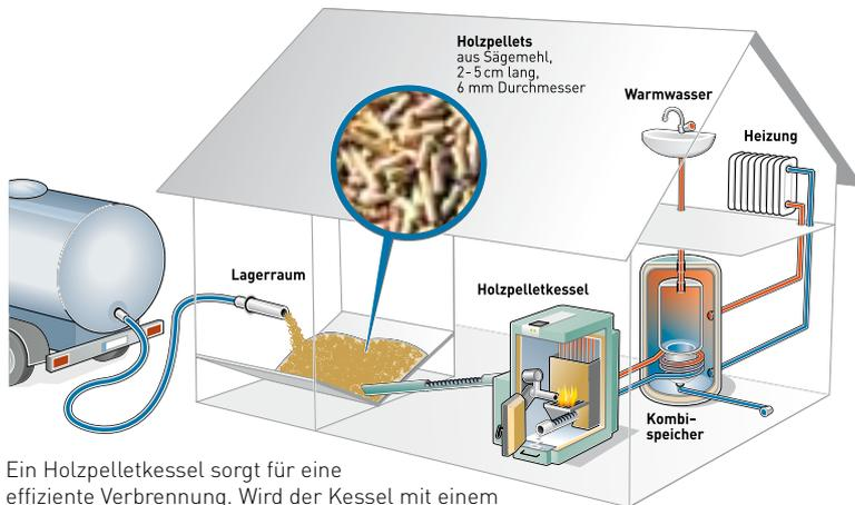
Ein Holzpelletkessel sorgt für eine effiziente Verbrennung. Wird der Kessel mit einem Pufferspeicher gekoppelt, können Emissionen weiter gesenkt und besonders hohe Wirkungsgrade erreicht werden.
