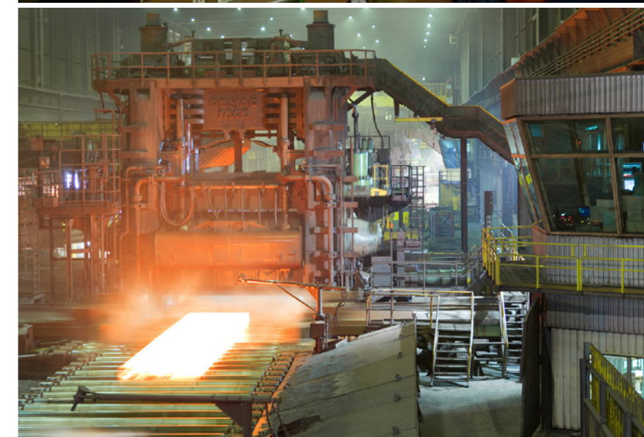
Stahlproduktion in der Dillinger Hütte. Oben ist der Steuerstand Vorgerüst 1 zu sehen, unten das Walzwerk. Quelle: Dillinger Hütte.
